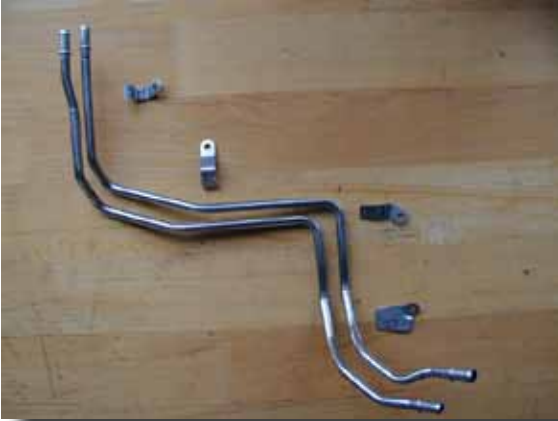
Bild 1 - Einzelteile , komplex gebogene Leitungen
